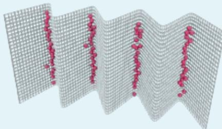
•Malha 30 significa que existem 30 orifícios entre os arames horizontais ou verticais em cada polegada de filtro.
