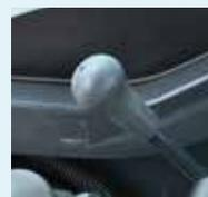
A alavanca da lâmina frontal possui controle piloto hidráulico para movimentação precisa.
