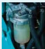
Pré filtro de combustível com a função de separador de água
