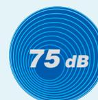
A 1 m atrás da máquina e 1,5 m de altura do nível do solo.
