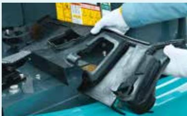
Tapete dividido em duas partes para fácil limpeza
